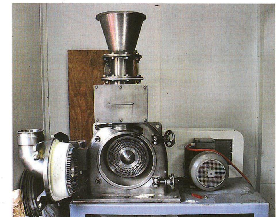
On aperçoit les rangées de broches sur la partie mobile (à l'intérieur) qui tourne à une vitesse de 10 000 tours minute et s'emboîte sur les broches de la partie fixe (l'élément ouvert). Le blé arrive par un conduit au-dessus et la farine est expédiée vers le tamis en bas.
